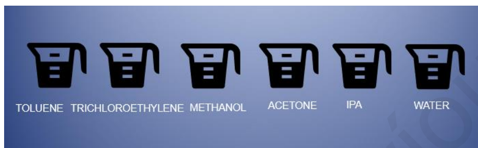
Εικόνα 3.2: Οργανικοί διαλύτες που χρησιμοποιούνται για τον καθαρισμό των υποστρωμάτων
