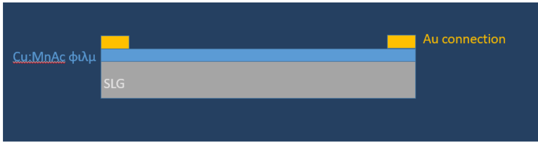
Εικόνα 3.18: Υπόστρωμα SLG στο οποίο έγινε εναπόθεση λεπτού φιλμ Cu:MnAc με επαφές χρυσού
