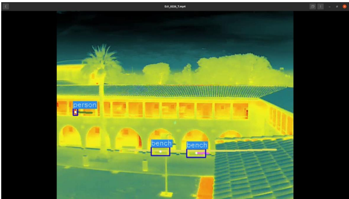
Εικόνα 10-13: Στιγμιότυπο οθόνης θερμικής κάμερας με ανίχνευση σε δύσκολη τοποθεσία.
