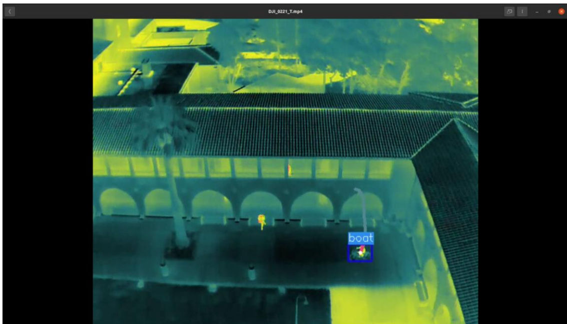
Εικόνα 10-5: Στιγμιότυπο οθόνης θερμικής κάμερας με αρνητικά bounding boxes και λανθασμένη ετικέτα.
