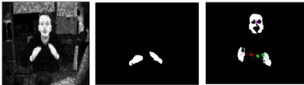
Εικόνα 9. Αρχική εικόνα χειρονομίας Εικόνα 10. Ανίχνευση κινούμενων χεριών Εικόνα 11. Αναγνώριση χειροκροτήματος
