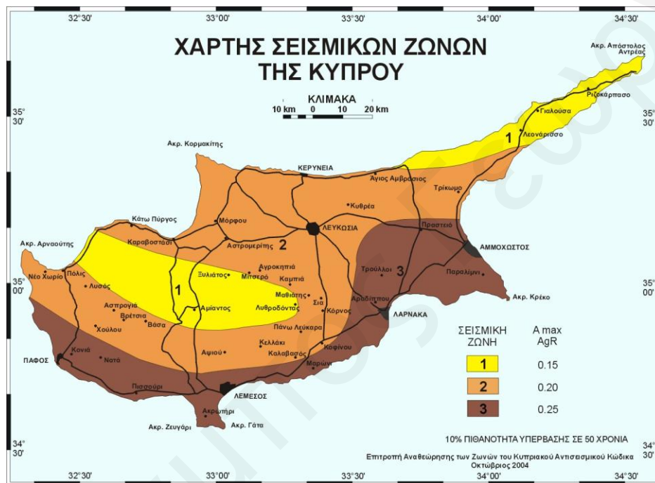
Σχήμα 5.1. Χάρτης σεισμικών ζωνών Κύπρου (Πηγή: National Annex to CYS EN 1998-1:2005 Eurocode 8: Design of Structures for Earthquake Resistance. Part 1: General Rules, Seismic Actions and Rules for Buildings).
