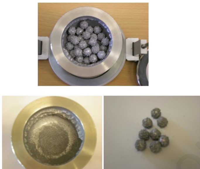
Σχήμα 3.14: Μπάλες και δοχείο σφαιρόμυλου, από ανοξείδωτο χάλυβα, μετά το πέρας της ξηρής μηχανικής κραμάτωσης.
