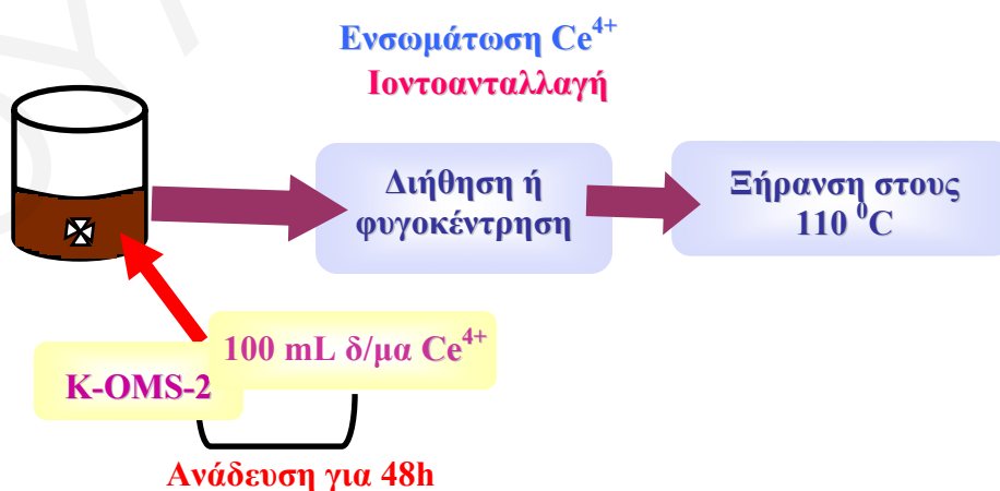
Σχήμα 3.1.2: Διαδικασία Ιοντοανταλλαγής
