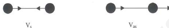
Σχήμα 2.2.1: Διάφοροι τύποι δονήσεων: οι συμμετρικές ( \nu_s ), οι ασύμμετρες ( \nu_{as} ) και οι δονήσεις κάμψης ( \delta ).
