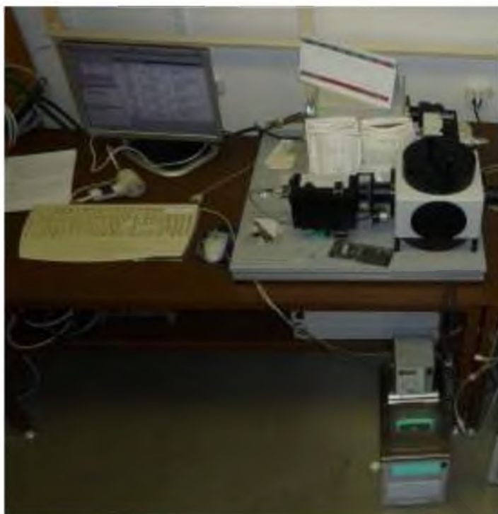
Σχήμα 6.22: Εικόνα φασματομέτρου που χρησιμοποιήθηκε για τη μελέτη των μικυλιακών συστημάτων του DPC μέσω της τεχνικής της χρονικά εξαρτώμενης απόσβεσης φθορισμού, TRFQ, σε εργαστήρια του τμήματος Βιοφυσικής Χημείας, στο Ινστιτούτο Φυσικοχημείας Jaroslav Heyrovský, στην Πράγα.
