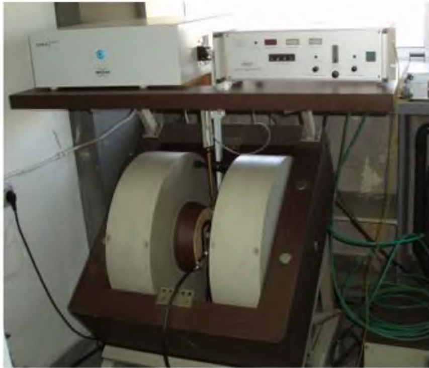
Σχήμα 6.13: Εικόνα φασματομέτρου EPR που χρησιμοποιήθηκε για τη μελέτη των μικυλιακών συστημάτων του DPC μέσω της τεχνικής Φασματοσκοπίας Ηλεκτρονικού Παραμαγνητικού Συντονισμού. Τα πειράματα πραγματοποιήθηκαν σε εργαστήρια του Ινστιτούτου Βιολογικών Ερευνών και Βιοτεχνολογίας, στο Εθνικό Ίδρυμα Ερευνών, που βρίσκεται στην Αθήνα, Ελλάδα.
