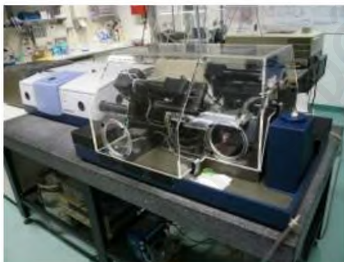
Σχήμα 6.9: Εικόνα φασματομέτρου που χρησιμοποιήθηκε για τη μελέτη των μονοστιβάδων του DPPC μέσω της τεχνικής φασματοσκοπίας ανάκλασης απορρόφησης υπέρυθρου σε εργαστήρια του Ινστιτούτου Max Planck στο Πότσταμ.
