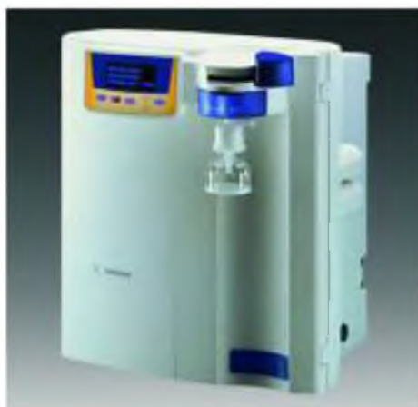
Σχήμα 6.1: Συσκευή παραγωγής “υπερκαθαρού” νερού Arrium 611UV της Sartorius.
