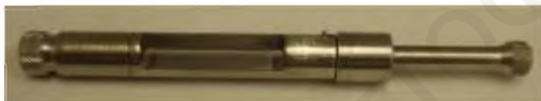
Σχήμα 6.20: Εικόνα της τριχοειδούς κυψελίδας που χρησιμοποιήθηκε για την εισαγωγή των δειγμάτων των μικυλιακών συστημάτων του DPC κατά τη μελέτη τους με την τεχνική της Σκέδασης των Ακτίνων X υπό μικρή γωνία.
