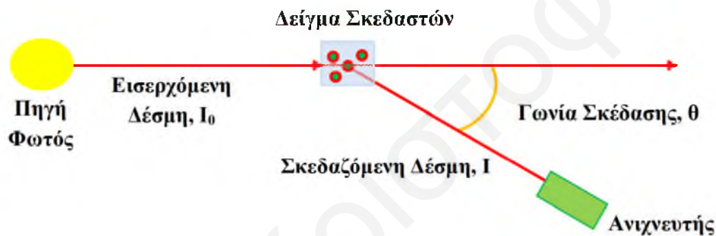
Σχήμα 4.16: Σχηματική αναπαράσταση της γεωμετρίας της σκέδασης.
