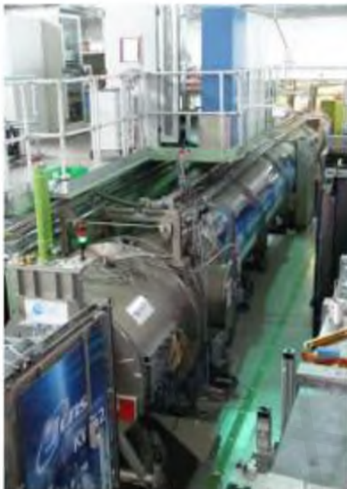
Σχήμα 6.17: Εικόνα των συστημάτων SANS που χρησιμοποιήθηκαν για τη μελέτη των μικυλιακών συστημάτων του DPC στο Julich Centre for Neutron Science FRMII (KWS 2) [iv] και στο Laboratoire Léon Brillouin, στο Saclay (PAXY) [v] .
