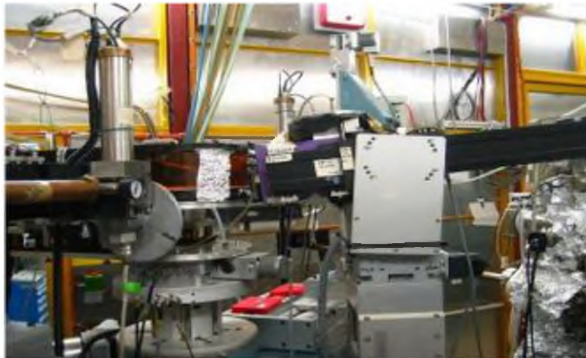
Σχήμα 6.7: Εικόνα περιθλασομέτρου που χρησιμοποιήθηκε για τη μελέτη των μονοστιβάδων μέσω της τεχνικής περίθλασης ακτίνων X υπό μικρή γωνία στο σύγχροτρο HASYLAB DESY στο Αμβούργο.
