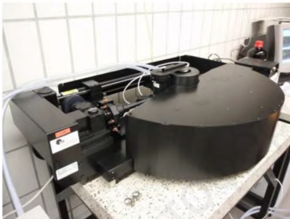
Σχήμα 6.15: Εικόνα συσκευής σκέδασης που χρησιμοποιήθηκε για τη μελέτη των μικυλιακών συστημάτων του DPC μέσω της τεχνικής της Δυναμικής Σκέδασης σε εργαστήριο του Ινστιτούτου Φυσικοχημείας και Θεωρητικής Χημείας του Τμήματος Χημείας και Φαρμακευτικής του Πανεπιστημίου Regensburg, στη Γερμανία.
