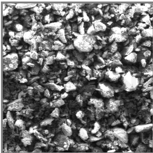
Σχήμα 4.20: Εικόνα SEM δουνίτη μετά από προσρόφηση ουρανίου
