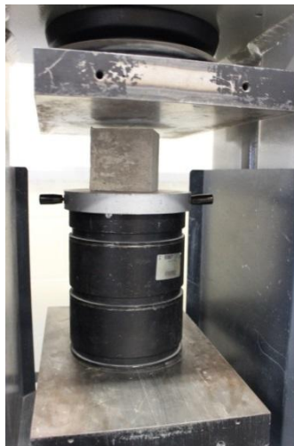
Εικόνα 5.18: Κυβικό δοκίμιο σκυροδέματος στη μηχανή θραύσης.
