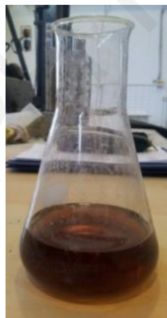
Εικόνα 5.16: Προσθήκη υπερρρευστοποιητή στο μίγμα.
