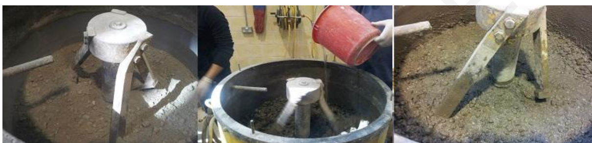
Εικόνα 5.14: Ανάμιξη υλικών για παρασκευή σκυροδέματος σε κυλινδρικό αναδευτήρα.
