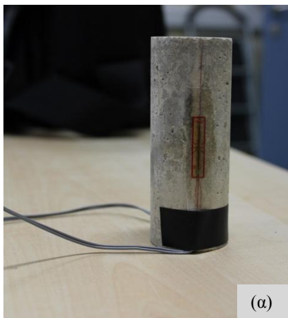
Εικόνα 5.33: Δοκιμή προσδιορισμού στατικού μέτρου ελαστικότητας κονιαμάτων: (α) επικόλληση ηλεκτρομηκυνσιόμετρων, (β) πειραματική διάταξη.
