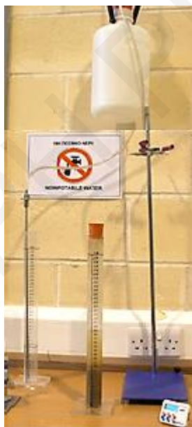
Εικόνα 5.5: Πειραματική διάταξη για προσδιορισμό του συντελεστή ισοδύναμου άμμου.
