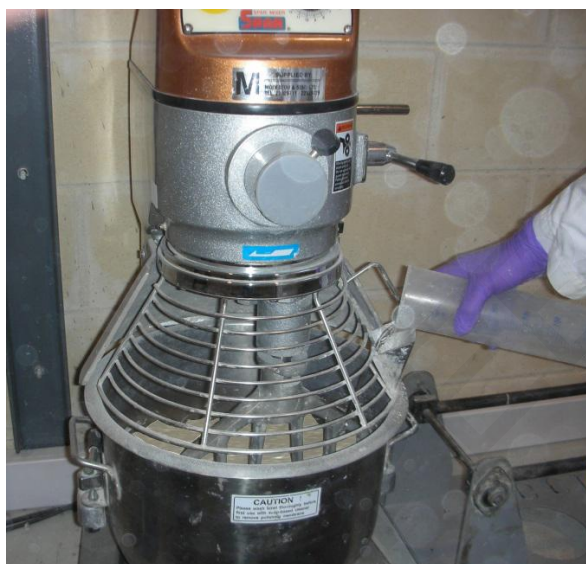
Εικόνα 5.27: Προσθήκη νερού και ανάμιξη υλικών για παρασκευή κονιαμάτων.
