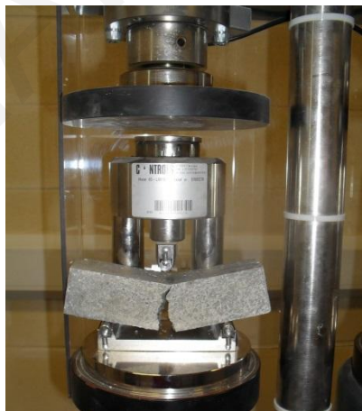
Εικόνα 5.31: Αστοχία πρισματικού δοκιμίου κονιάματος σε καμπτική καταπόνηση.
