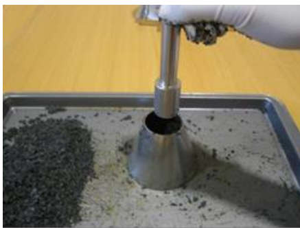
Εικόνα 5.7: Προσδιορισμός κατάστασης επιφανειακής ξήρανσης (SSD) δείγματος άμμου με τη χρήση ειδικού κώνου.
