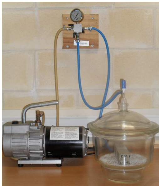
Εικόνα 5.35: Δοκιμή προσδιορισμού ανοικτού πορώδους και φαινόμενης πυκνότητας κονιάματος.
