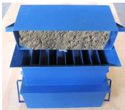
Εικόνα 5.2: Συσκευή (riffle box) και διαδικασία διαχωρισμού δειγμάτων.
