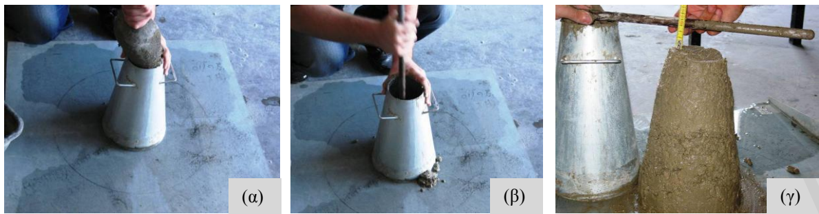
Εικόνα 5.15: Δοκιμή κάθισης: (α) συμπλήρωση κώνου με σκυρόδεμα (β) συμπύκνωση στρώσης και (γ) μέτρηση κάθισης.
