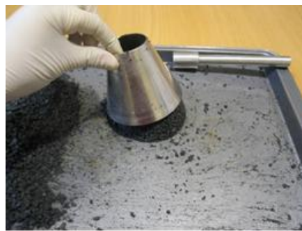
Εικόνα 5.7: Προσδιορισμός κατάστασης επιφανειακής ξήρανσης (SSD) δείγματος άμμου με τη χρήση ειδικού κώνου.
