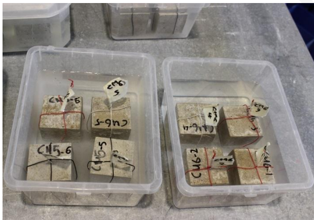
Εικόνα 5.37: Κυβικά δοκίμια εμβαπτισμένα μέσα σε κορεσμένο διάλυμα θειικού μαγνησίου.
