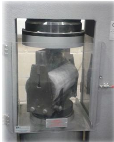
Εικόνα 5.20: Κυλινδρικό δοκίμιο σκυροδέματος στη μηχανή θραύσης.
