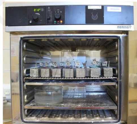
Εικόνα 5.38: Κυβικά δοκίμια κατά την φάση ξήρανσης σε φούρνο.
