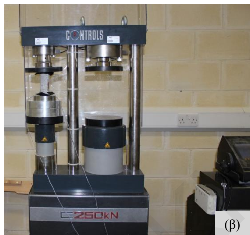
Εικόνα 5.33: Δοκιμή προσδιορισμού στατικού μέτρου ελαστικότητας κονιαμάτων: (α) επικόλληση ηλεκτρομηκυνσιόμετρων, (β) πειραματική διάταξη.
