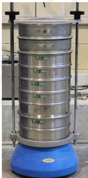
Εικόνα 5.3: Πρότυπα κόσκινα τοποθετημένα στη συσκευή κοσκίνιματος.
