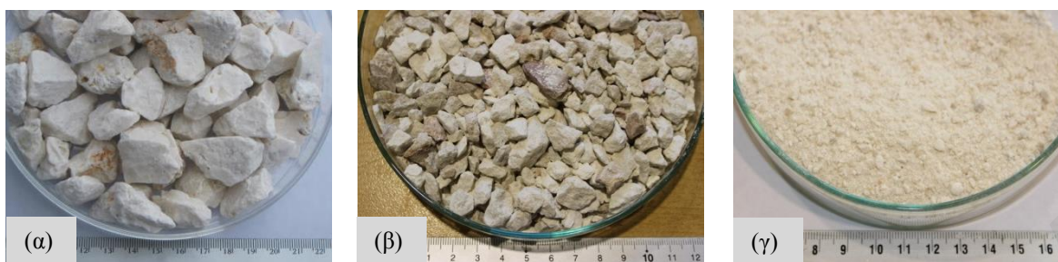
Εικόνα 4.18: (α) Ασβεστολιθικά σκύρα μεγέθους 8-20 mm, (β) Ασβεστολιθικά σκύρα μεγέθους 4-10 mm, (γ) Ασβεστολιθική άμμος μεγέθους 0-4 mm.
