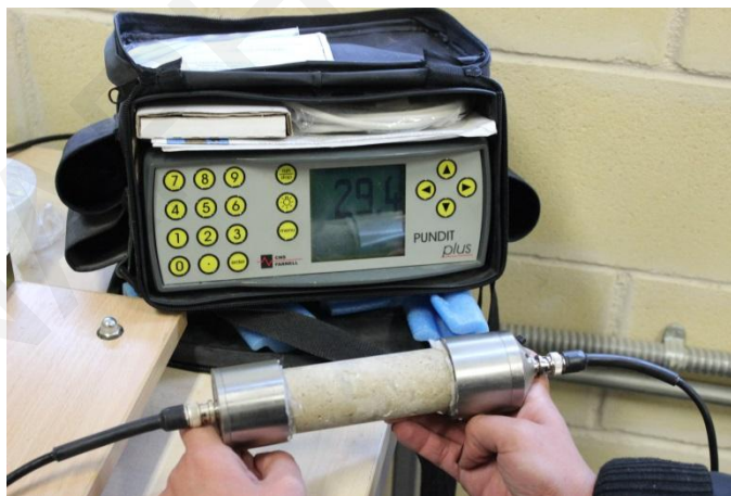
Εικόνα 5.34: Προσδιορισμός δυναμικού μέτρου ελαστικότητας κονιάματος.
