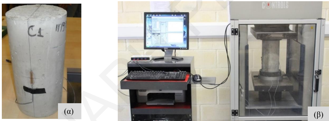
Εικόνα 5.21: Δοκιμή προσδιορισμού στατικού μέτρου ελαστικότητας σκυροδεμάτων: (α) επικόλληση ηλεκτρομηκυσσιόμετρων, (β) πειραματική διάταξη.
