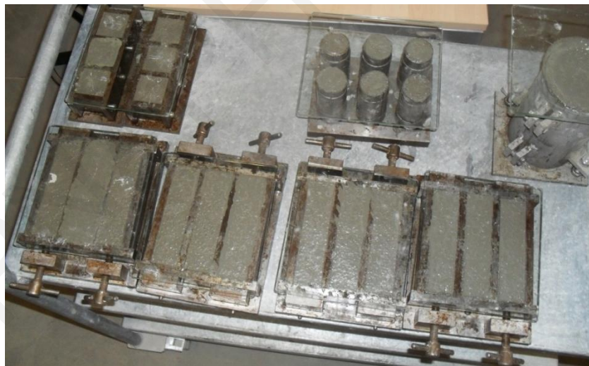
Εικόνα 5.30: Συντήρηση δοκιμίων κονιαμάτων σε μήτρες που καλύπτονται με γυαλί.
