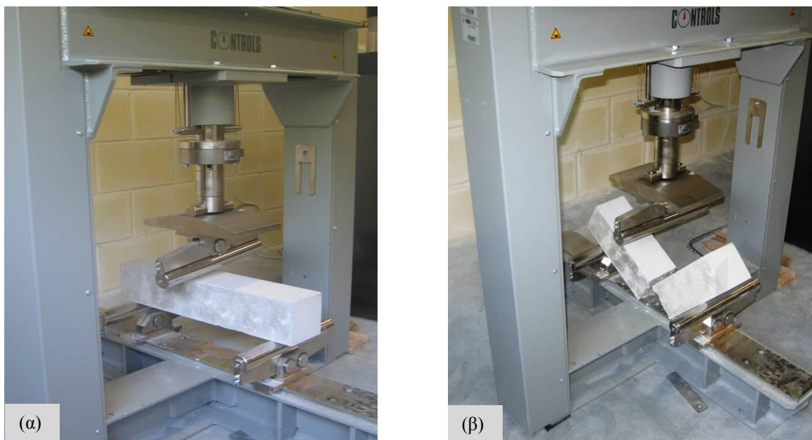
Εικόνα 5.19: Δοκιμή αντοχής σε κάμψη: (α) πρισματικό δοκίμιο σκυροδέματος στη μηχανή κάμψης, (β) αστοχία δοκίμιου σε καμπτική καταπόνηση.
