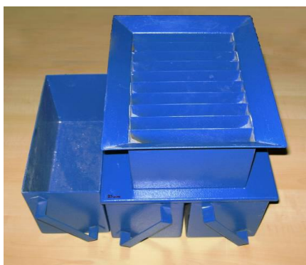
Εικόνα 5.2: Συσκευή (riffle box) και διαδικασία διαχωρισμού δειγμάτων.
