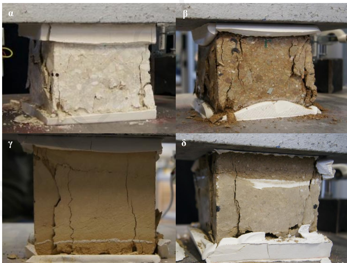
Εικόνα 48: Χαρακτηριστικές φωτογραφίες μορφών αστοχίας σε κυβικά δοκίμια ακμής 100 mm συμπιεσμένων ωμοπλίνθων. α) ΣΩ με χώμα Αλάμπρας, β) ΣΩ με χώμα Δελίκηπου, γ) ΣΩ με χώμα από το λατομείο Λατούρου και δ) ΣΩ με χώμα Τσερίου.
