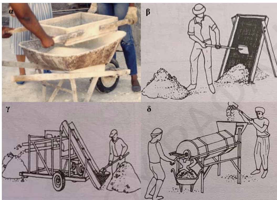
Εικόνα 6: α) Χειροκίνητο κόσκινο (Schroeder, 2016) β) Σκίτσο όπου παρατηρείται το κοσκίνισμα σε σταθερό κόσκινο γ) Σκίτσο όπου παρατηρείται η λειτουργία του δονητικού κόσκινου δ) Σκίτσο με χειροκίνητο περιστροφικό κόσκινο (Houben and Guillaud, 1994).
