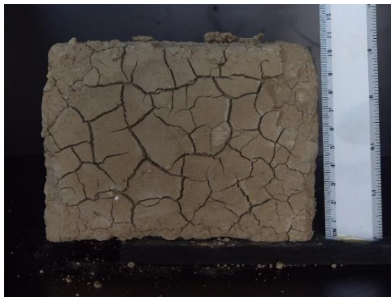
Εικόνα 60: Φωτογραφία ΣΩ με χώμα από την περιοχή Τσερίου στο οποίο παρατηρούνται εκτεταμένες crazing-type ρωγμές.
