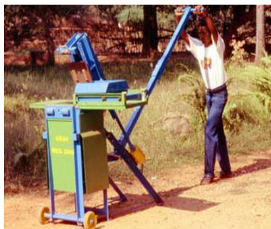
Εικόνα 9: Χειρωνακτική πρέσα βαρέου τύπου, Auram 3000 (earth-auroville).
