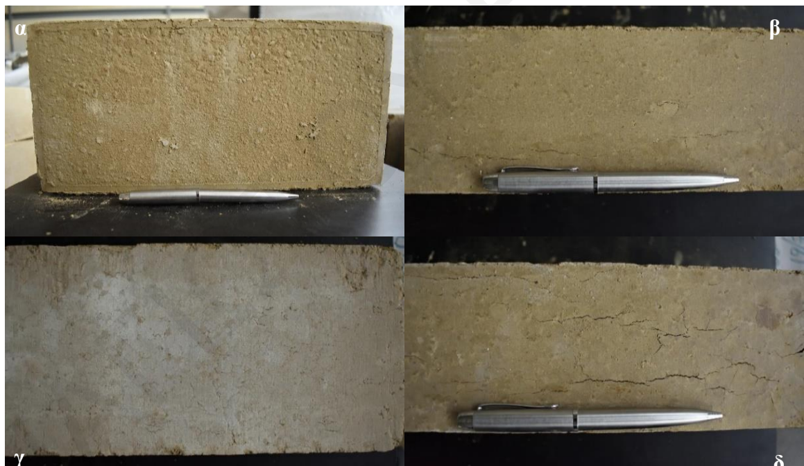
Εικόνα 36: Μακροσκοπικές εικόνες από τους συμπιεσμένους ωμόπλινθους με χώμα από την περιοχή του Τσερίου. α) Κάτω επιφάνεια συμπιεσμένου ωμόπλινθου στην οποία παρατηρείται καλή συνοχή του υλικού, β) Λεία πλαϊνή επιφάνεια, με ρωγμή κάθετα στη διεύθυνση της συμπίεσης, γ) Επανθίσεις από άλατα ή οργανικό υλικό στην άνω επιφάνεια (300 mm x 150 mm x 100 mm), δ) Μεγάλες ρωγμές, κάθετες στη διεύθυνση της συμπίεσης.
