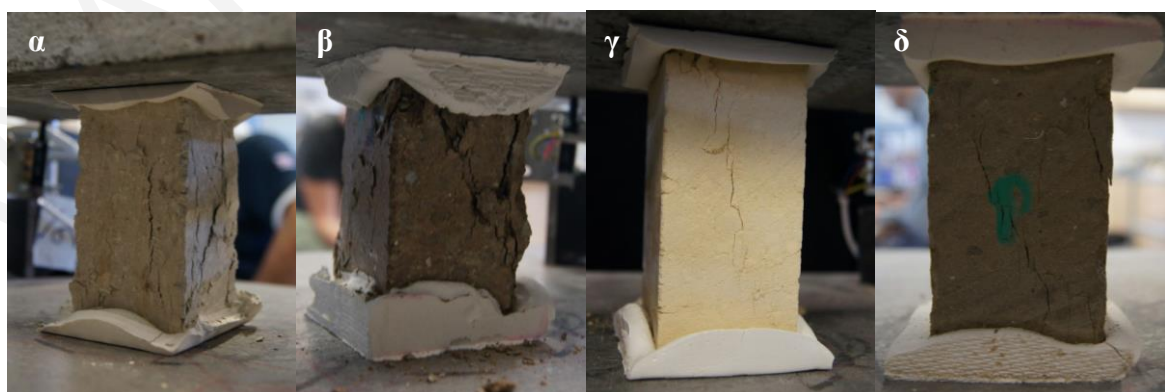
Εικόνα 50: Χαρακτηριστικές φωτογραφίες μορφών αστοχίας σε πρισματικά δοκίμια διαστάσεων 50 mm x 50 mm x 100 mm συμπίεσμένων ωμοπλίνθων. α) ΣΩ με χρώμα Αλάμπρας, β) ΣΩ με χρώμα Δελίκηπου, γ) ΣΩ με χρώμα από το λατομείο Λατούρου και δ) ΣΩ με χρώμα Τσερίου.
