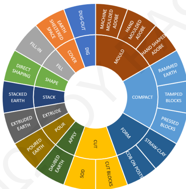
Εικόνα 3: Κατηγορίες τεχνικών γήινης δόμησης (Houben and Guillaud, 1994, τροποποιημένο από τον συγγραφέα).
