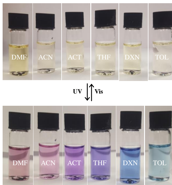
Σχήμα 3.7.7. Δείγματα συγκέντρωσης 0.5% MS στους έξι οργανικούς διαλύτες πριν και μετά την ακτινοβολήση με UV.
