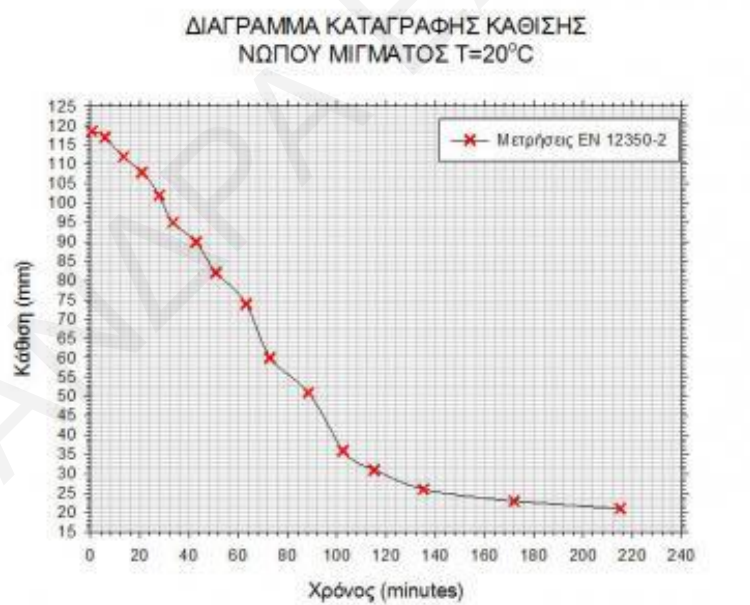
Εικόνα 24 : Διάγραμμα μετρήσεων κάθισης κατά ΕΛΟΤ EN 12350-21
