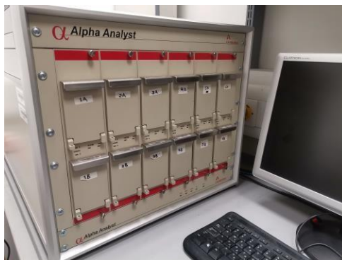
Σχήμα 4: Θάλαμοι α-φασματοσκοπίας στους οποίους εφαρμόζεται κενό και συνδέονται με τα ηλεκτρονικά μέρη του συστήματος
