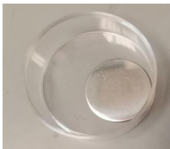
Σχήμα 14: Εναπόθεση των ραδιονουκλιδίων σε μεταλλικά πλακίδια
