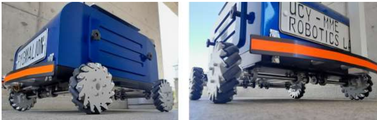
Σχήμα 3-20: Πρωτότυπο ρομπότ με τροχούς mecanum προοπτικά από χαμηλό σημείο
