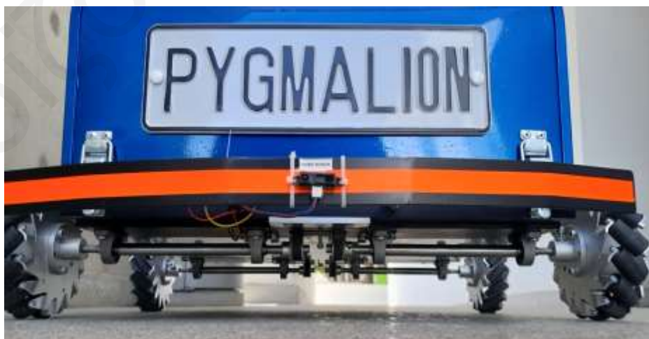
Σχήμα 3-34: Μπροστινό μέρος ρομπότ με αισθητήρα απόστασης υπερύθρων
