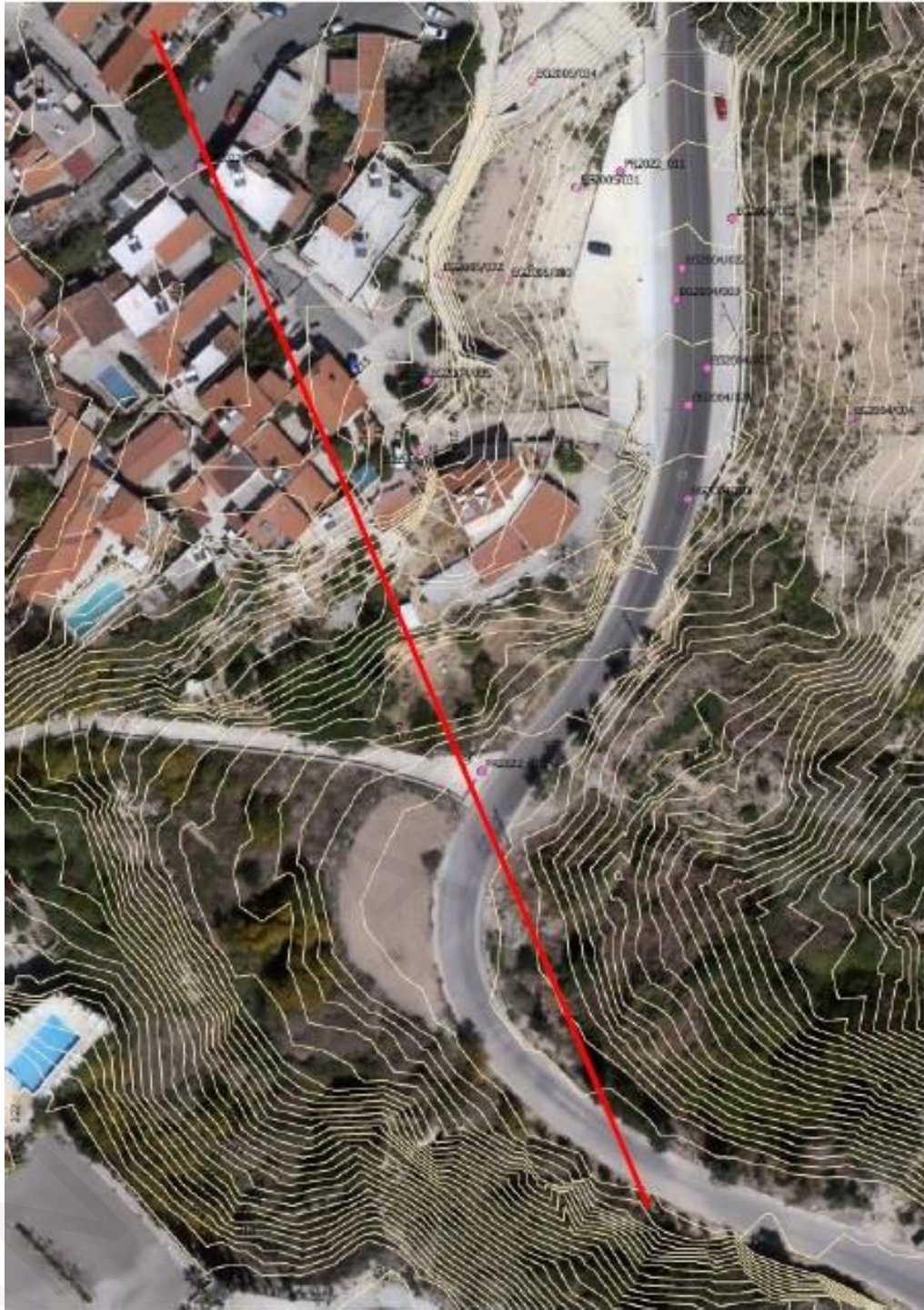
Σχήμα 16: Τομή η οποία αναλύθηκε στο πρόγραμμα Slide
