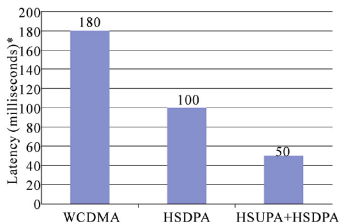
Σχήμα 3.2 : Καθυστέρηση WCDMA, HSDPA και HSPA(HSDPA + HSUPA) [7]
