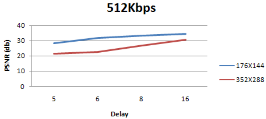
Σχήμα 32. PSNR για ρυθμό κωδικοποίησης 512Kbps
