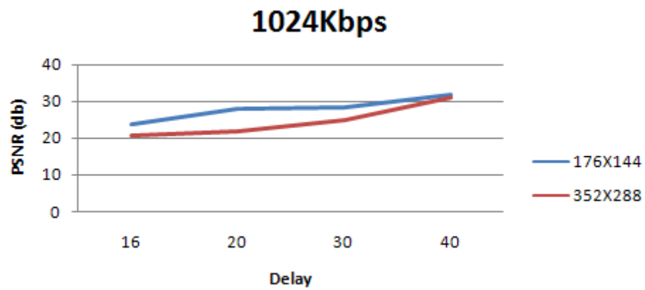
Σχήμα 33. PSNR για ρυθμό κωδικοποίησης 1024Kbps
