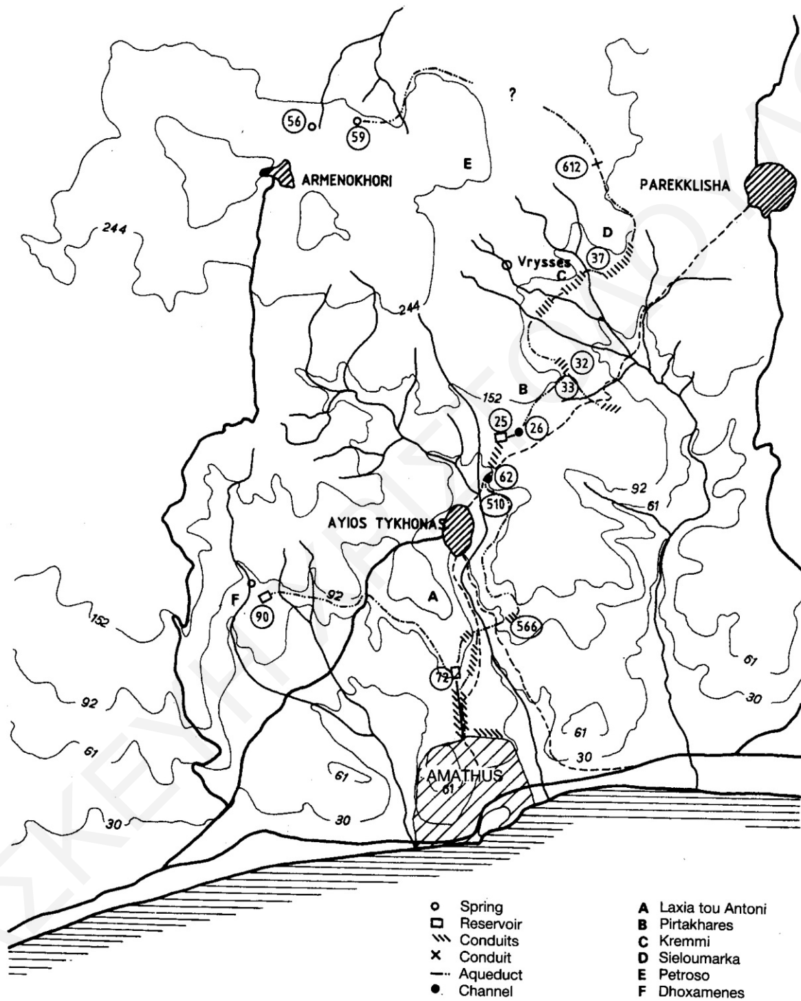
Εικ. 216: Σχέδιο υδροδότησης Αμαθούντας (Last 1975, κάτοψη 21).
