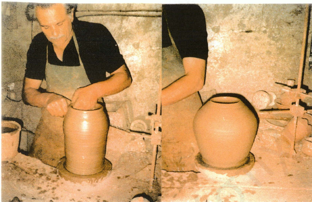
Εικ. 2.7 α Κατασκευή αμφορέα LR1 με τη μέθοδο του "Οξυπύθμενου Αμφορέα" - Στάδιο 1
