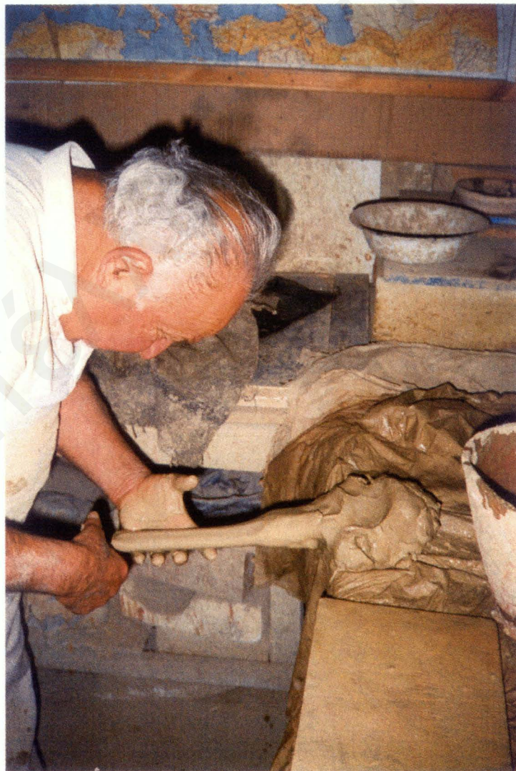
Εικ. 2. 6 Μέθοδος κατασκευής της "τραβηχτής λαβής"
