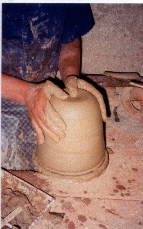
Εικ. 2.5 α Κατασκευή αμφορέα LR1 με τη μέθοδο της "Κούζας του Βαρωσιού" - Στάδια 1-4
