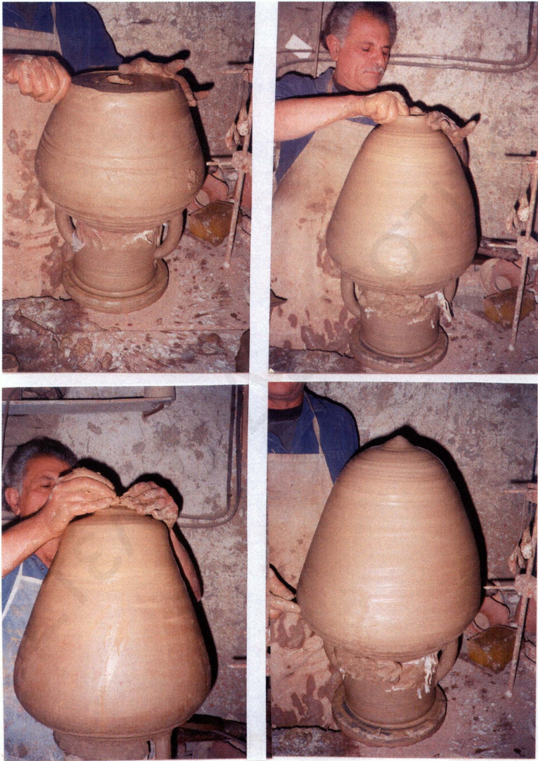
Εικ. 2.7 ζ Κατασκευή αμφορέα LR13 με τη μέθοδο του "Όξυπύθμενου αμφορέα" - Στάδιο 3
