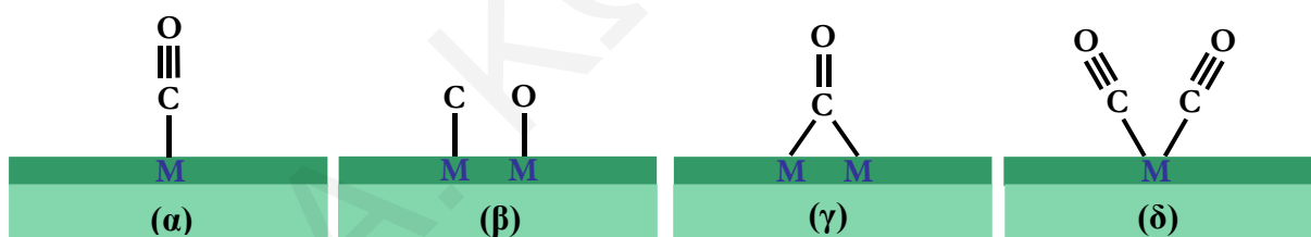
Σχήμα 2.11. Δομές χημικά προσροφημένων ειδών CO σε μεταλλικές επιφάνειες [35].
