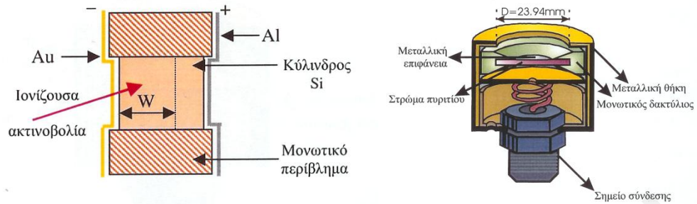
Σχήμα 3.22: Απεικόνιση ανιχνευτή επιφανειακού φράγματος πυριτίου
