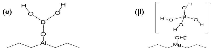
Σχήμα 2.2: Προτεινόμενος μηχανισμός δέσμευσης B(III) στις επιφάνειες (α) Al_2O_3 (pH 8) και (β) MgO (pH 10)
