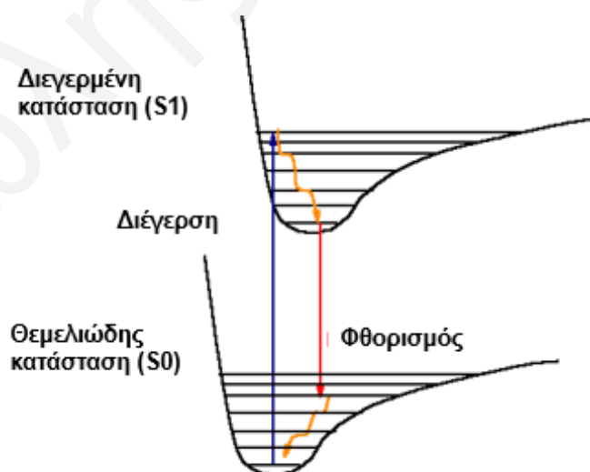
Σχήμα 2.1: Βασική και διεγερμένη κατάσταση στο φθορισμό.
