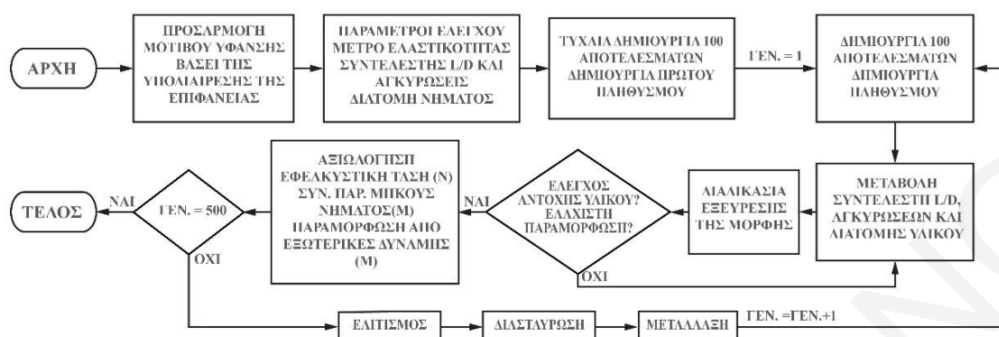
Εικόνα 5.20. Διάγραμμα ροής διαδικασίας βελτιστοποίησης κλειστού βρόγχου ανατροφοδότησης.
