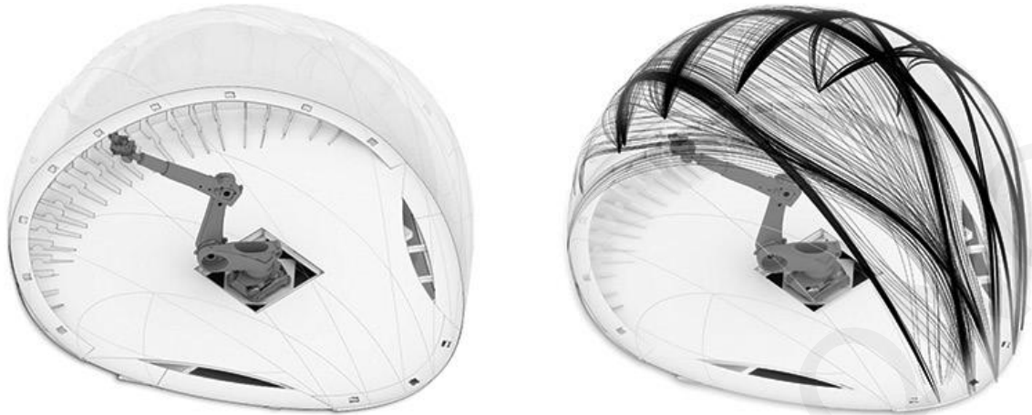
Εικόνα 2.15. Διάγραμμα συσχετισμού επιτρεπόμενου χώρου εργασίας ρομποτικού βραχίονα με την τελική μορφή (Vasey et al., 2015).
