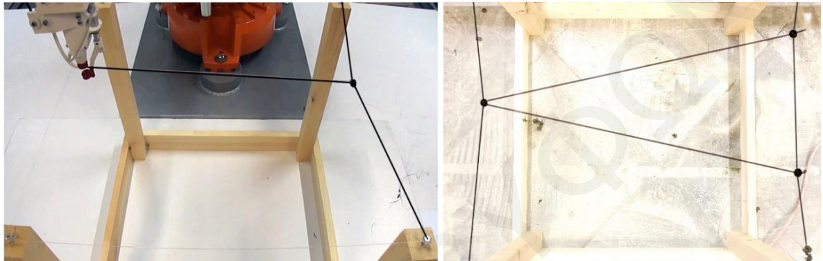
Εικόνα 7.2. Πείραμα εξεύρεσης μορφής και συσχέτιση με προσθήκη δυο ελαστικών νημάτων (Kontonourkis and Tryfonos, 2015a; Kontonourkis and Tryfonos, 2016).
