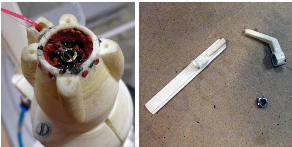
Εικόνα 7.6. Φθορές άκρου ημισφαιρίου και αστοχία αρπαγής.
