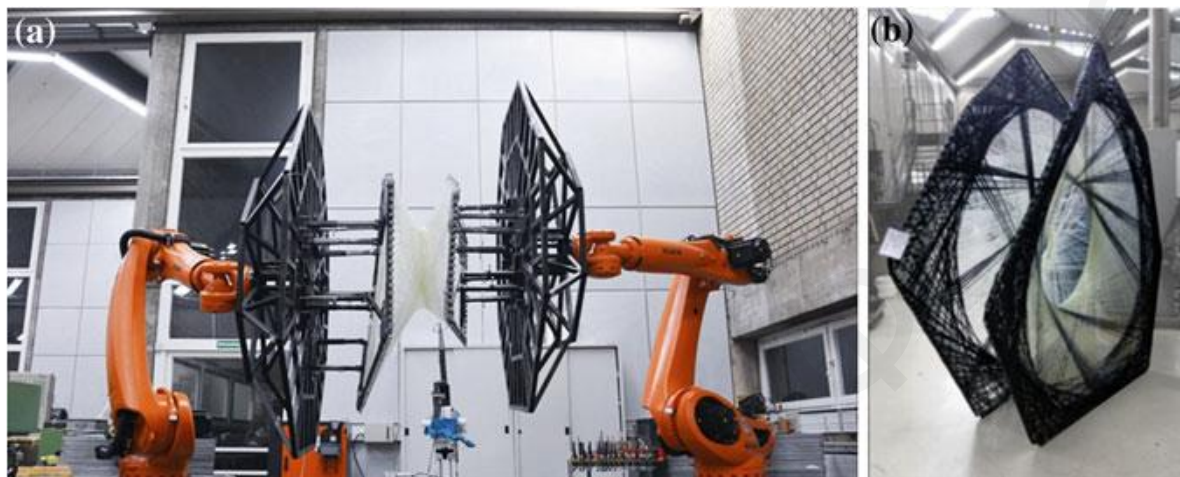
Εικόνα 2.8. Χώρος εργασίας του 12-αξονικού ρομποτικού συστήματος για τη δημιουργία των μονάδων (Prado et al., 2014).
