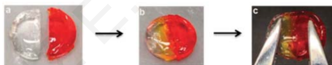
Σχήμα 1.3.69: Φωτογραφίες από το πείραμα αυτο-επιδιόρθωσης του ΔΟΠΠ P(DMA 0.68 -co-DAA 0.32 ) / PDD: (a) Δύο κομμάτια ΔΟΠΠ P(DMA 0.68 -co-DAA 0.32 ) / PDD, ένα με χρωστική και ένα χωρίς χρωστική. (b) Συμπίεση των δύο κομματιών ΔΟΠΠ κατά μήκος των κομμένων επιφανειών. (c) Αυτο-επιδιόρθωση και 'ένωση των δύο κομματιών σε ένα ενιαίο κομμάτι [136].
