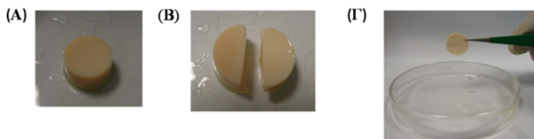
Σχήμα 3.1.9: Πείραμα αυτο-επιδιόρθωσης των οργανοπλεγμάτων P-D gel. (A) Οργανόπλεγμα με P : D ίσο με 2 : 4 μετά από σύνθεση. (B) Το ίδιο οργανόπλεγμα κομμένο σε δύο κομμάτια. (Γ) Τα δύο κομμάτια οργανοπλέγματος ενώθηκαν σε ένα κομμάτι μετά από τη διαδικασία αυτο-επιδιόρθωσης.
