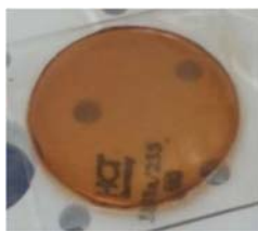
Σχήμα 3.5.10: Φωτογραφία του PVDF electrolyte gel που περιέχει τον ιοντικό υγρό ηλεκτρολύτη LiTFSI : EMIM-TFSI.
