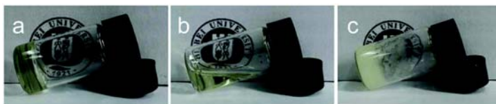
Σχήμα 1.4.9: (a και b) Μετάβαση πλέγμα-σε-διάλυμα και (b και c) μετάβαση διάλυμα-σε-πλέγμα των τυχαία διασταυρωμένων οργανοπλεγμάτων σε DMF κατά τη διαδοχική προσθήκη οξέος και βάσης, αντίστοιχα [144].
