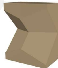
Εικόνα 53: Περίπτωση μέγιστης και ελάχιστης θλιπτικής αντοχής για τον ωμόπλινθο
