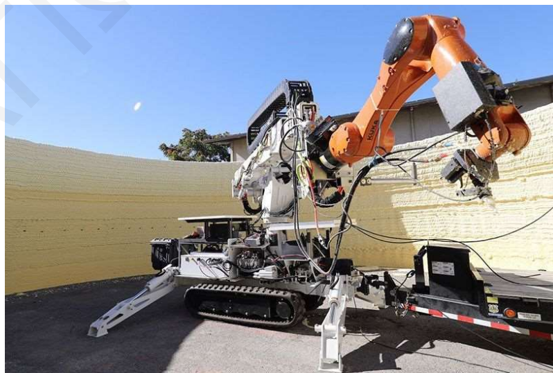
Εικόνα 21: Digital Construction Platform-τρειςδιάστατη εκτύπωση μεγάλης κλίμακας τοιχοποιίας επί τόπου (Keating et al, 2017)
