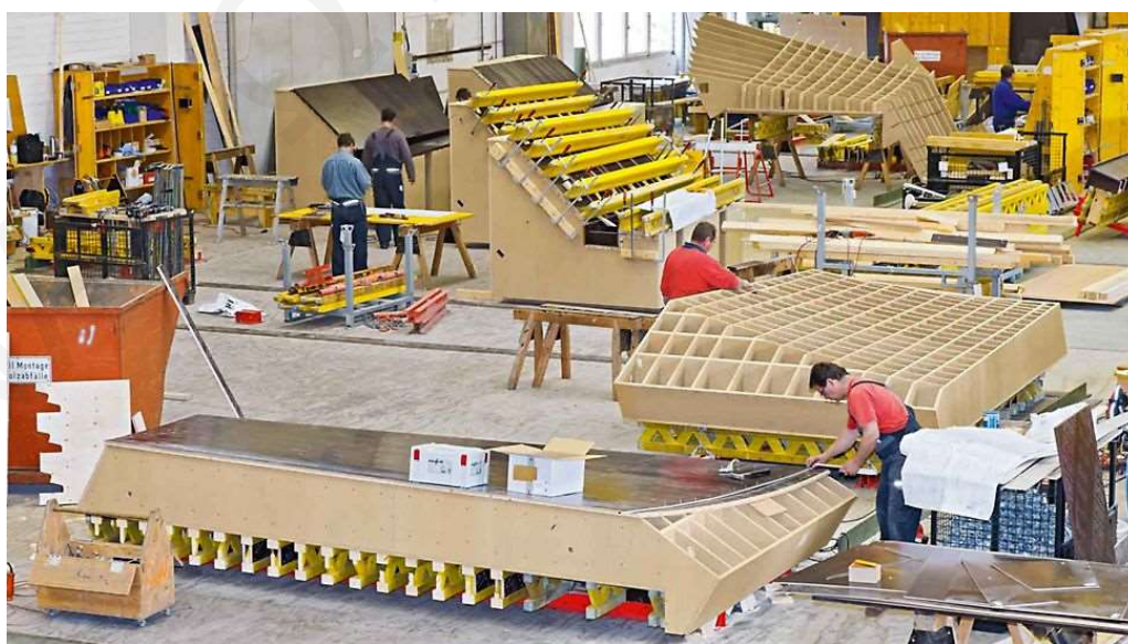
Εικόνα 6: Ξυλότυπος PERI με τη χρήση της μεθόδου κοπής ξύλων [4]
