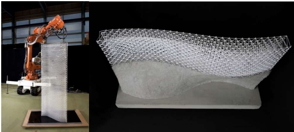
Εικόνα 22: Κατασκευή ενίσχυσης και πλήρωσης τοιχοποιίας με τη χρήση ειδικών εργαλείων τελικής δράσης (Hack et al, 2013 )
