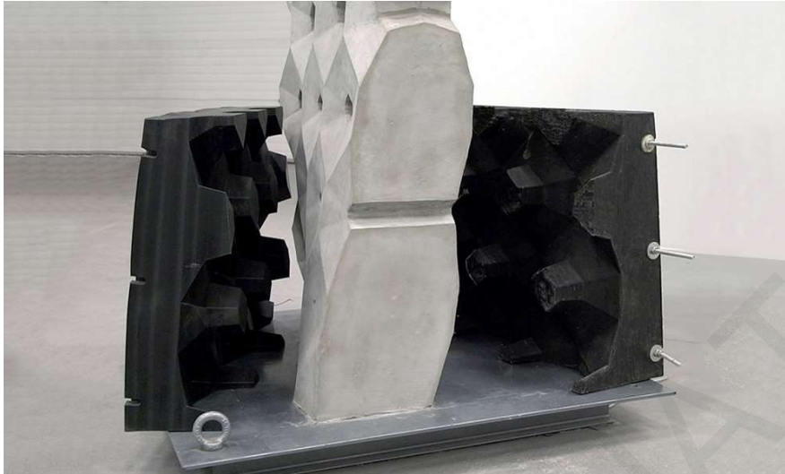
Εικόνα 20: Παραγωγή δομικών στοιχείων με τη χρήση καλουπιών παραγόμενων με τη μέθοδο τρισδιάστατης εκτύπωσης [9]
