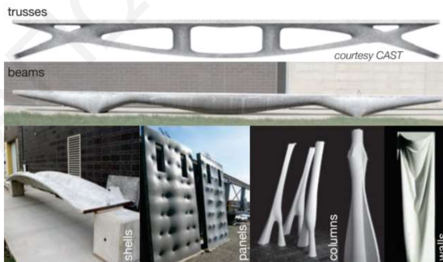
Εικόνα 11: Παραγωγή δομικών στοιχείων με τη χρήση υφασμάτινων καλουπιών [7]
