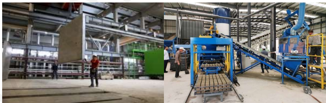
Εικόνα 2: Διαδικασία παραγωγής τμημάτων τοιχοποιίας εκτός εργοταξίου (off site) / Διαδικασία παραγωγής τούβλων εκτός εργοταξίου (off site) [2]
