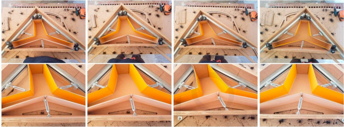
Εικόνα 14: Καλούπι δομικού στοιχείου με τη χρήση αρθρωτού μηχανισμού (Kontonourkis et al, 2019)
