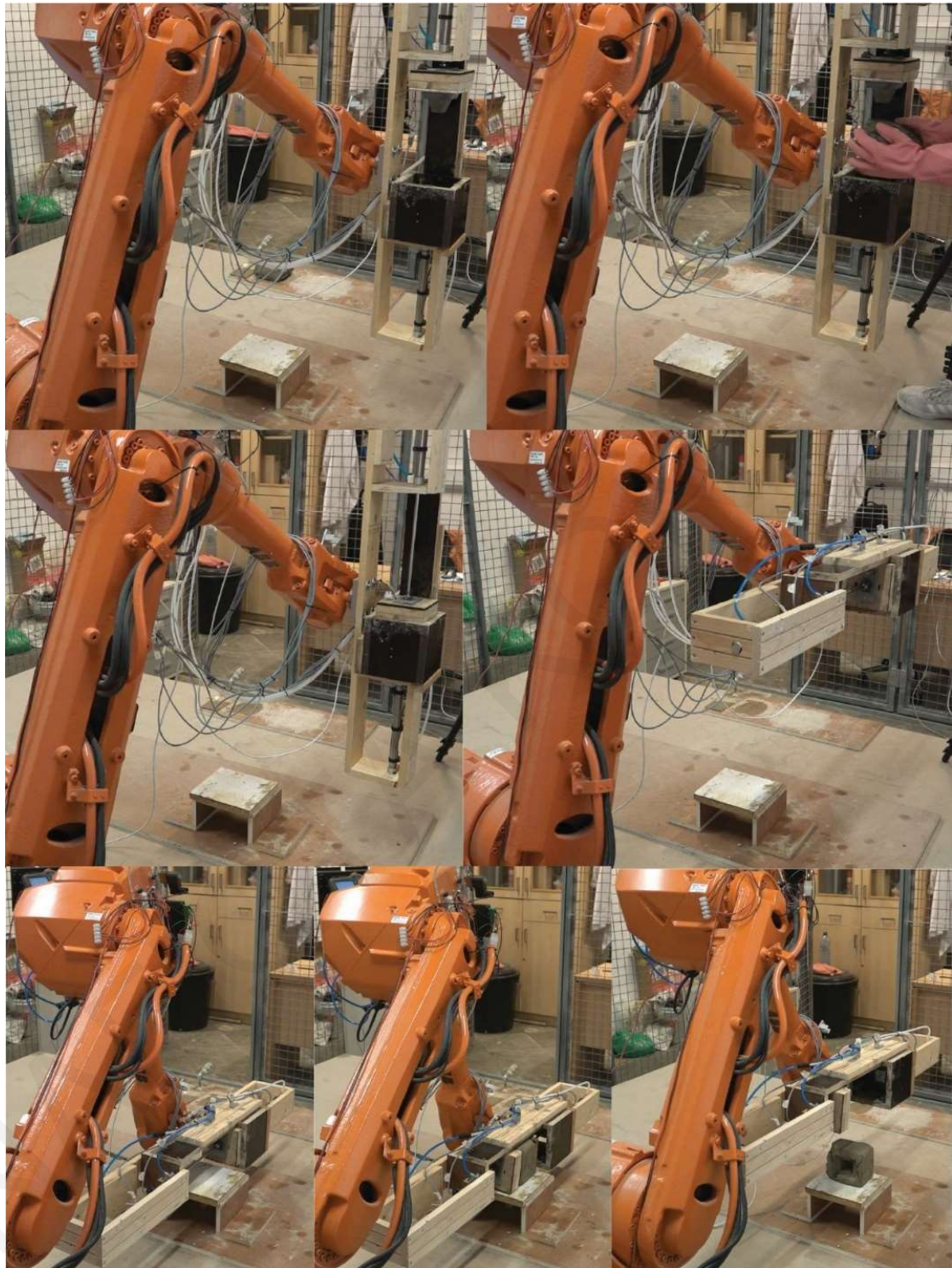
Εικόνα 49: Στιγμιότυπα της φυσικής διαδικασίας παραγωγής ενός δομοστοιχείου
