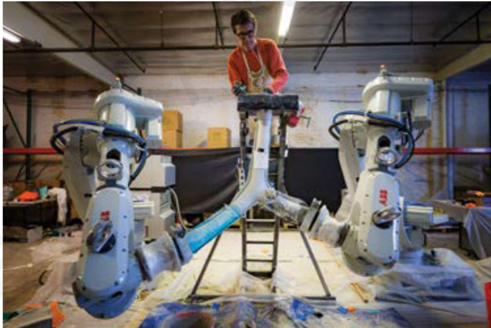
Εικόνα 13: Form Found Founded Design project- μορφολόγηση καλουπιού με μεμβράνη με τη χρήση ρομποτικών βραχιόνων (West and Araya, 2010)
