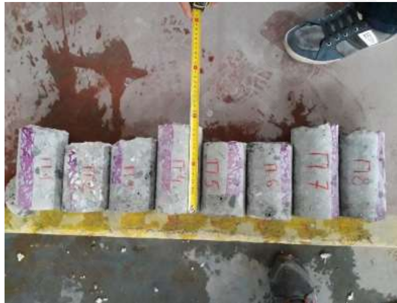
Εικόνα 3.27: Προσδιορισμός του βάθους ενανθράκωσης
