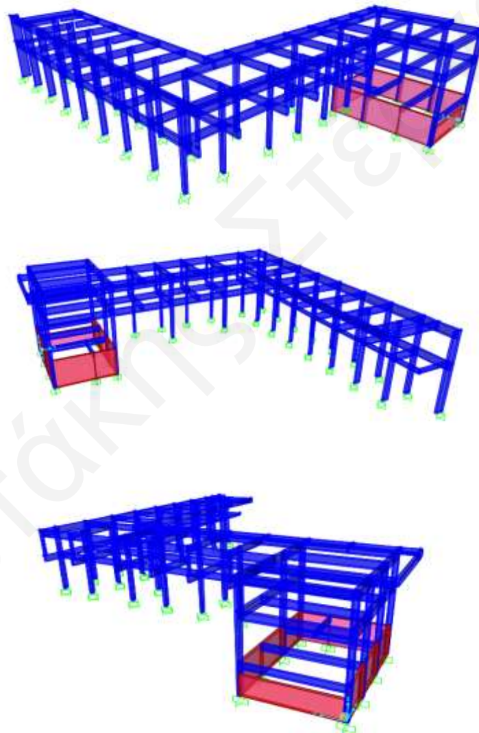
Εικόνα 4.10: Προσομοίωμα νοτιοανατολικού τμήματος - Όψεις (α) Νοτιοανατολική, (β) Βορειοδυτική (γ) Βορειοανατολική
