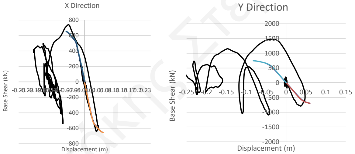
Γράφημα 7.17: Base Shear – Displacement στην X - Διεύθυνση (RSN 5814)
