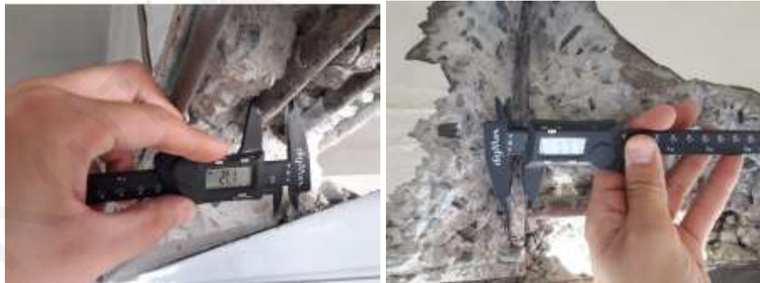
Εικόνα 4.3: Μέτρηση διαμέτρου σπλισμού (CEARS Cyprus)
