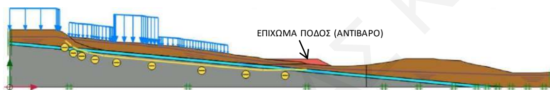
Σχήμα 5.8. Τομή της περιοχής της κατολίσθησης μετά την τοποθέτηση του επιχώματος του 2 ου σεναρίου μέτρων σταθεροποίησης.
