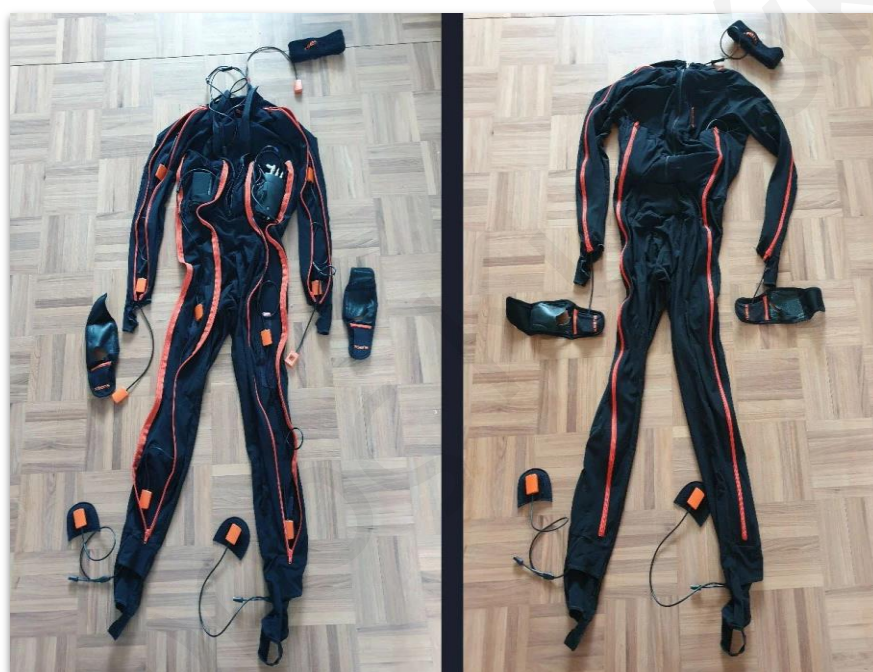
Εικόνα 2.5: Παράδειγμα στολής από inertial system [22]
