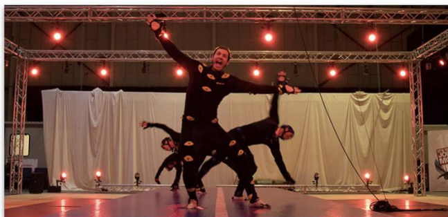
Εικόνα 2.3: Παράδειγμα οπτικού συστήματος mocap με passive markers [19], [20]
