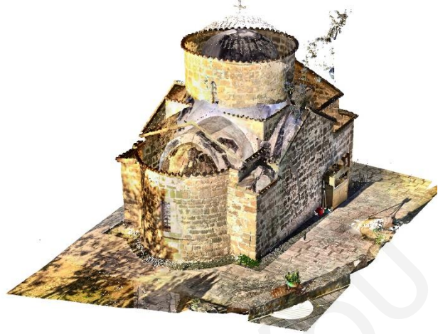
Εικ.8 Νέφος Σημείων από σάρωση με Laser Scanner
