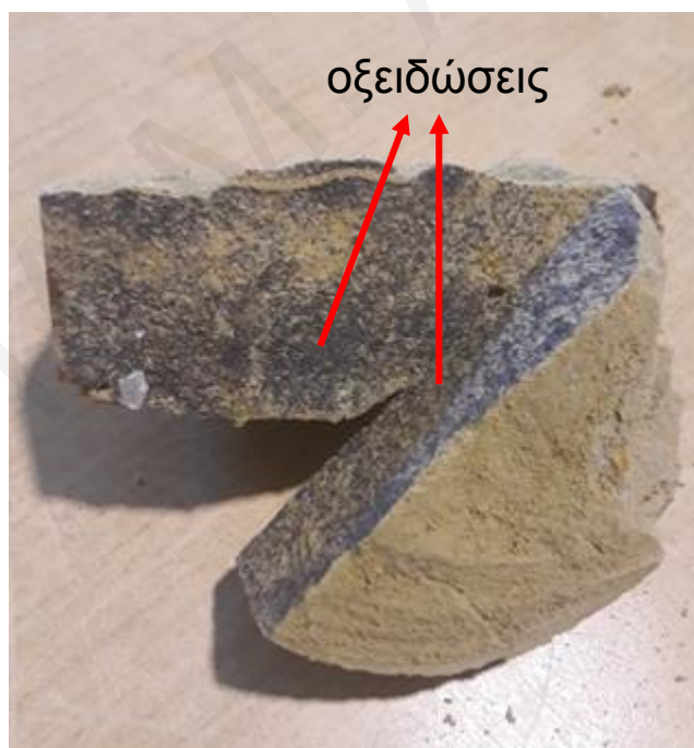
Σχήμα 6.7: Παρουσία οξειδώσεων σε φυσική ασυνέχεια δείγματος μάργας Λευκωσίας.
