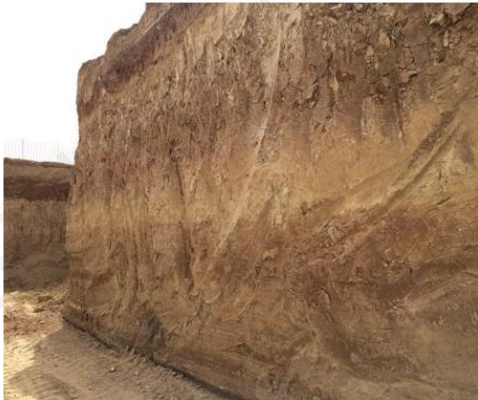
Σχήμα 4.4: Κατακόρυφο πρανές μάργας του Σχηματισμού Λευκωσίας.
