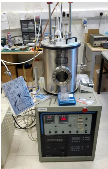
Εικόνα 4.20: Απεικόνιση διάταξης Magnetron Sputtering.
