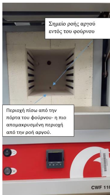
Εικόνα 4.39: Απεικόνιση φούρνου που χρησιμοποιείται για ανάπτυξη ηλεκτρικών επαφών.
