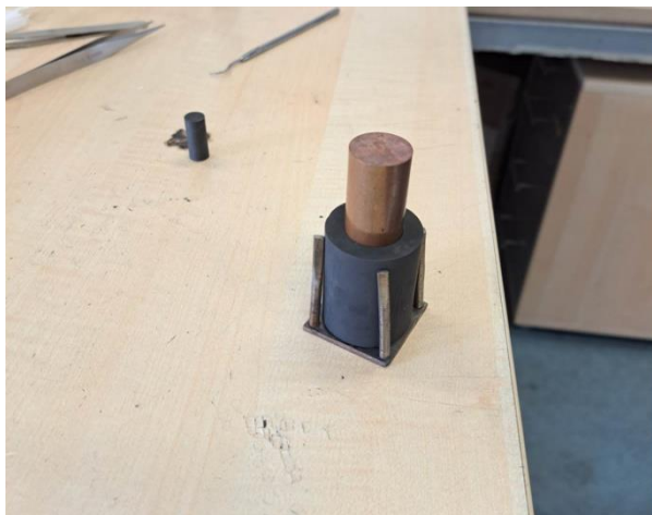
Εικόνα 5.7: Απεικόνιση τοποθέτησης κυλινδρικού χάλκινου κομματιού πάνω από την θερμοηλεκτρική γεννήτρια με 2 ζεύγη θερμοστοιχεία για άσκηση πίεσης.
