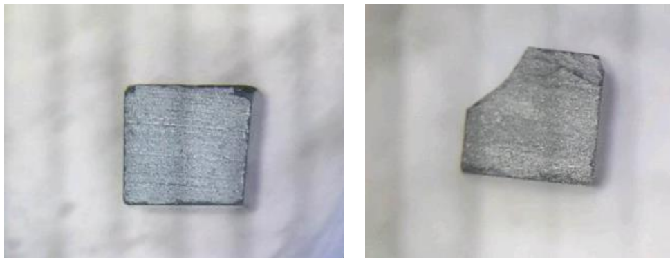
Εικόνα 4.34: Απεικόνιση διατομής θερμοστοιχείου τύπου η MSS (αριστερά) και τύπου ρ HMS (δεξιά).
