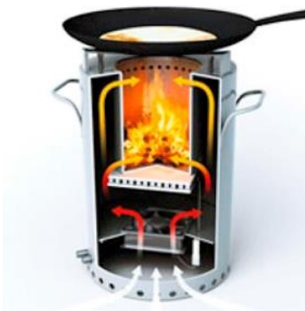
Εικόνα 1.8: Απεικόνιση συνδυασμού θερμοηλεκτρικής γεννήτριας και σόμπας βιομάζας.[23]
