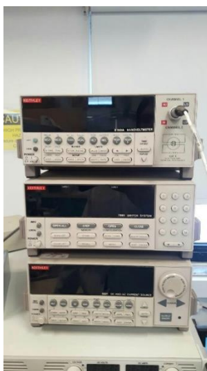
Εικόνα 4.43: Απεικόνιση των Keithley που χρησιμοποιούνται στην διάταξη μέτρησης αντίστασης ως προς την θέση του δείγματος.
