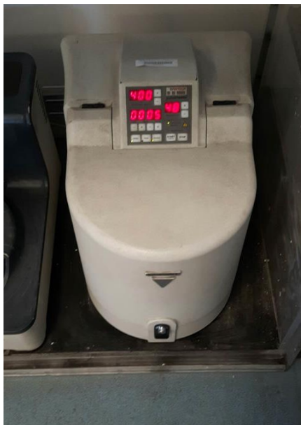
Εικόνα 4.4: Απεικόνιση μηχανήματος P6 για μηχανική άλεση.
