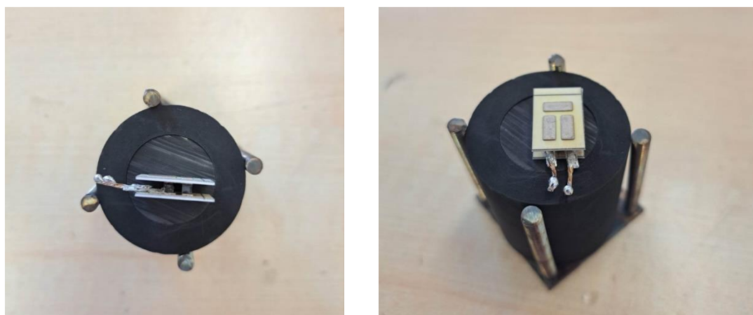
Εικόνα 5.12: Απεικόνιση θερμοηλεκτρικής γεννήτριας με κολλημένες μπαλίτσες καλάϊ στα ακρινά της ηλεκτρόδια.
