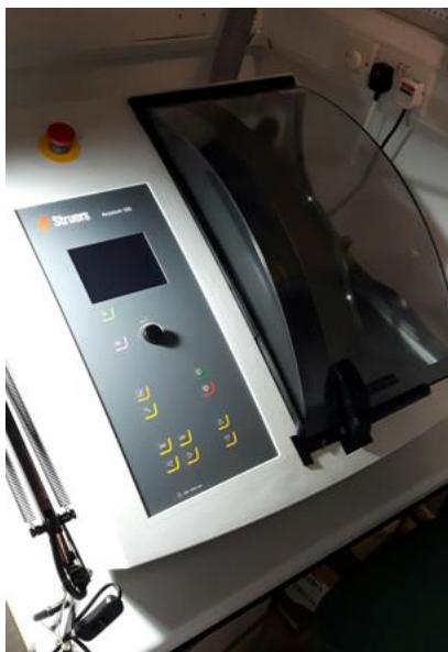
Εικόνα 4.9: Απεικόνιση μηχανήματος accustom-100.
