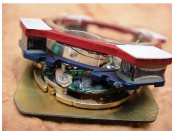
Εικόνα 1.6: Απεικόνιση θερμοηλεκτρικής γεννήτριας σε φορητό παλμικό οξύμετρο για μέτρηση του κορεσμού οξυγόνου στο αίμα. [19]
