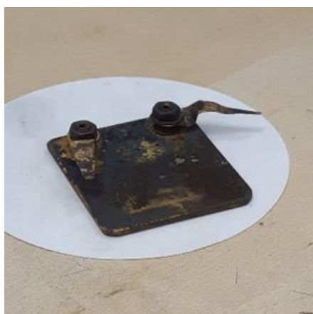
Εικόνα 4.38: Απεικόνιση βάσης συγκόλλησης δειγμάτων.
