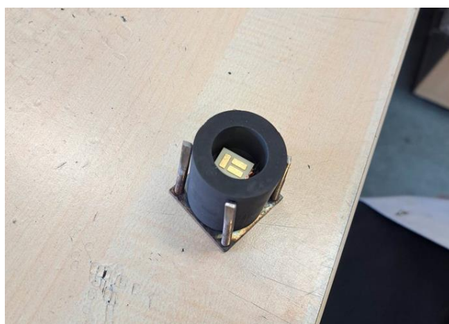
Εικόνα 5.6: Απεικόνιση θερμοηλεκτρικής γεννήτριας εντός της μήτρας γραφίτη.
