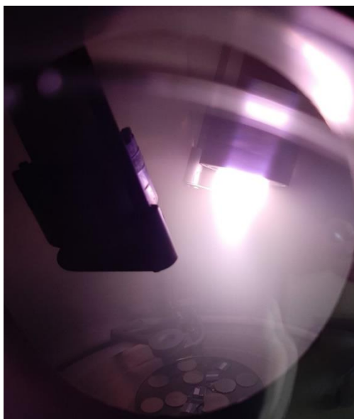
Εικόνα 4.22: Απεικόνιση διαδικασίας εναπόθεσης με Magnetron Sputtering.
