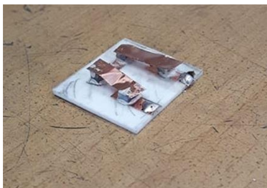
Εικόνα 4.10: Απεικόνιση θερμοηλεκτρικής γεννήτριας με θερμοστοιχεία διαφορετικού ύψους.
