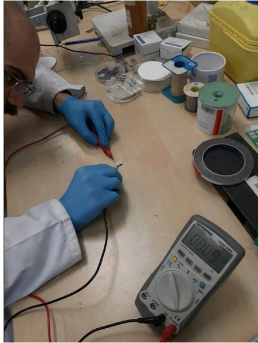
Εικόνα 5.8: Απεικόνιση εσωτερικής αντίστασης 1 ης θερμοηλεκτρικής γεννήτριας.
