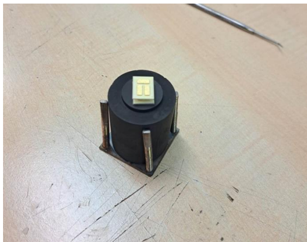
Εικόνα 5.5: Απεικόνιση θερμοηλεκτρικής γεννήτριας με 2 ζεύγη θερμοστοιχεία μετά την τοποθέτηση της άνω πλάκας alumina.
