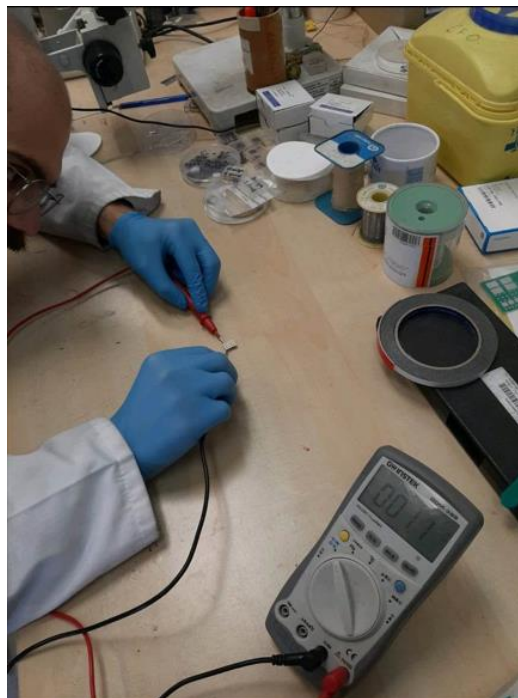
Εικόνα 5.9: Απεικόνιση εσωτερικής αντίστασης 2 ης θερμοηλεκτρικής γεννήτριας.
