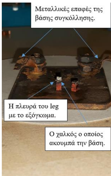
Εικόνα 4.51: Απεικόνιση εξογκώματος θερμοστοιχείων τύπου p HMS.
