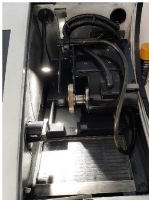
Εικόνα 5.5: Απεικόνιση του εσωτερικού του μηχανήματος Accutom – 100. Συγκεκριμένα απεικονίζεται ο τροχός λείανσης, ο ηλεκτροκινητήρας μαζί με τον άξονα του και ο άξονας που στερεώνεται η δαγκάνα.
