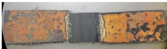
Εικόνα 5.19: Απεικόνιση ενός θερμοστοιχείου, ανάμεσα από δύο κομμάτια χαλκού ακριβώς μετά τη συγκόλληση στο φούρνο, με τη χρήση στερεοσκοπίου.
