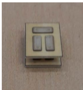
Εικόνα 6.8: Απεικόνιση της θερμοηλεκτρικής γεννήτριας 4 μετά τη συγκόλληση των θερμοστοιχείων στο φούρνο.
