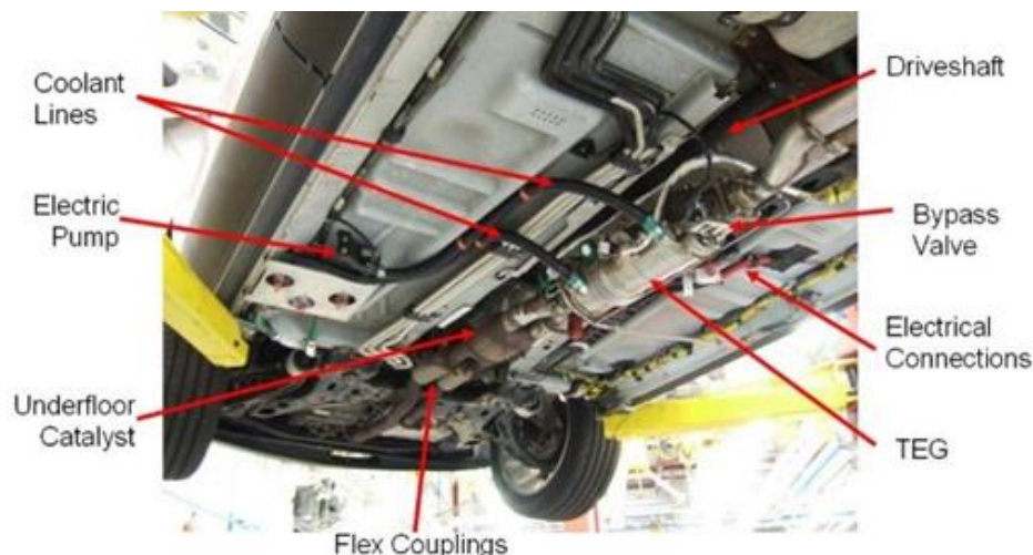
Εικόνα 1.13: Απεικόνιση θερμοηλεκτρικής γεννήτριας στο σύστημα εξάτμισης του οχήματος Lincoln MKT. [17]
