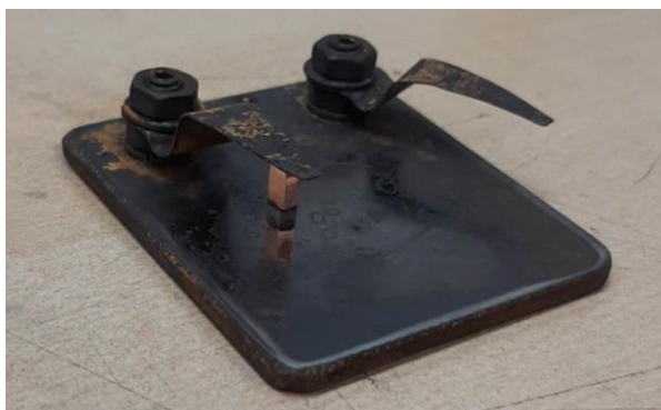
Εικόνα 5.18: Απεικόνιση της μεθόδου στήριξης των δειγμάτων για τη συγκόλληση τους στο φούρνο.
