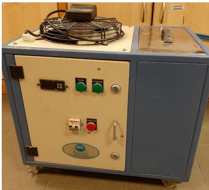
Εικόνα 6.22: Απεικόνιση του συστήματος ψύξης νερού.
