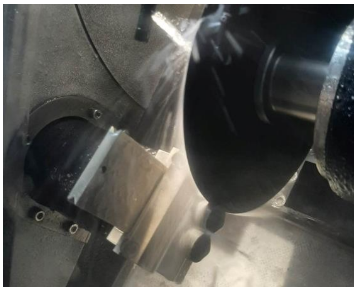
Εικόνα 6.20: Απεικόνιση της διαδικασίας κοπής των εμβόλων στο Accutom – 100.
