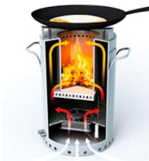
Εικόνα 1.11: Απεικόνιση συνδυασμού θερμοηλεκτρικής γεννήτριας με σόμπα βιομάζας.
