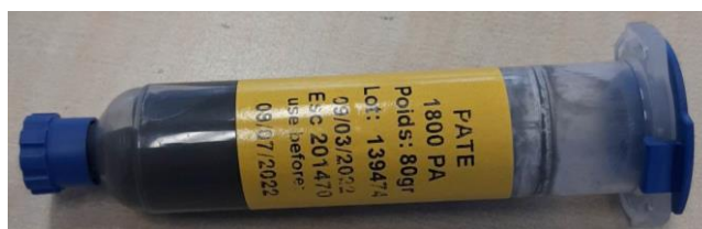
Εικόνα 6.3: Απεικόνιση της συγκολλητικής πάστας αργύρου 1800PA brazing paste. [51]
