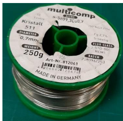
Εικόνα 6.7: Απεικόνιση του καλάι 99.3%Sn & 0.7%Cu (Lead free).
