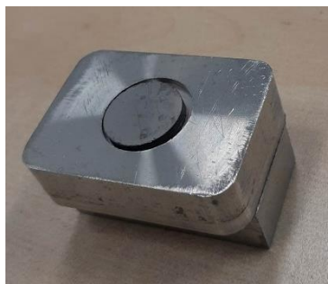
Εικόνα 5.4: Απεικόνιση του εξαρτήματος μείωσης ύψους δισκίων μαζί με ένα δισκίο τοποθετημένο στην οπή.
