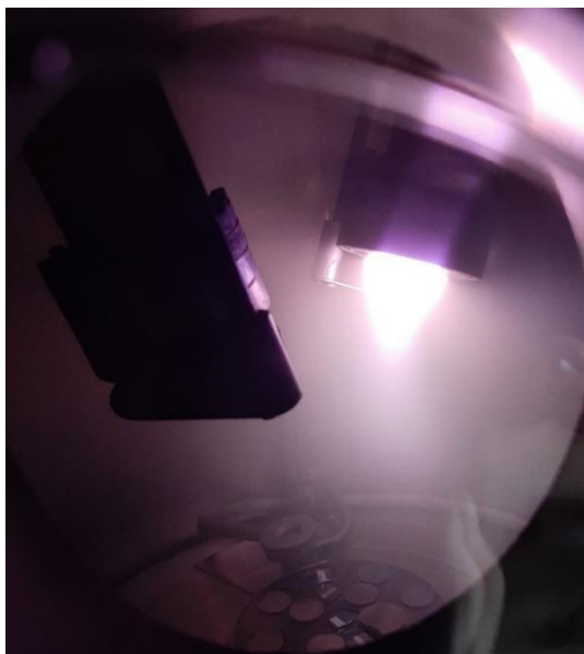
Εικόνα 5.10: Απεικόνιση της διαδικασίας magnetron sputtering.
