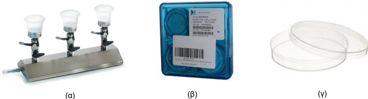
Εικόνα 4-1: Εξοπλισμός για διήθηση δειγμάτων (α) Σύστημα Διήθησης (β) Μεμβράνες Διήθησης (γ) Αποστειρωμένο τρυβλίο πετρί (petri dish)
