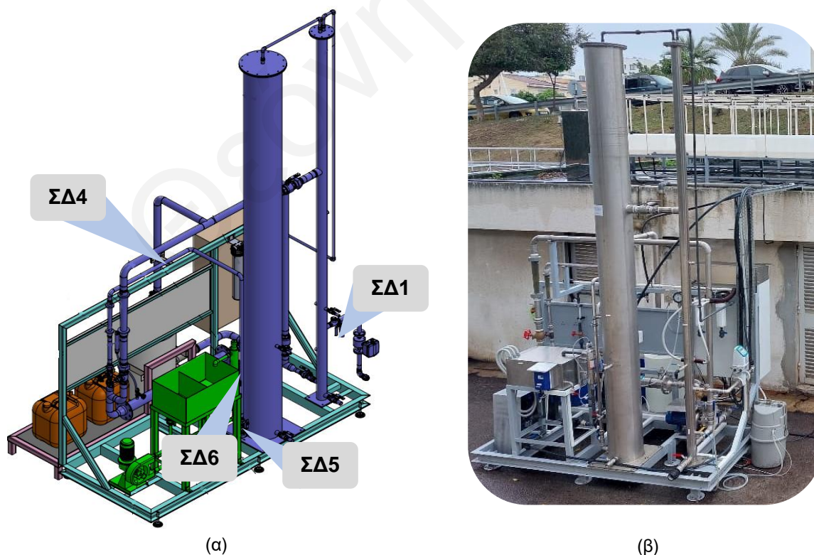
Σχήμα 3-2: (α) Προσχέδια πιλοτικής μονάδας με τα 4 σημεία δειγματοληψίας (β) Φωτογραφία εγκατεστημένης της πιλοτικής μονάδας
