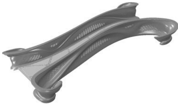
Εικόνα 4: Μοντέλο πεπερασμένων στοιχείων της γέφυρας (Αριστερά εικόνα) (Kyvelou, et al., 2022).
