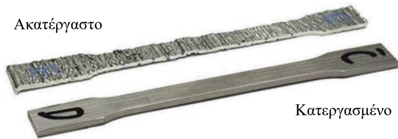
Εικόνα 8: Δοκίμια εφελκυσμού με και χωρίς κατεργασία (Kyvelou, et al., 2020).
