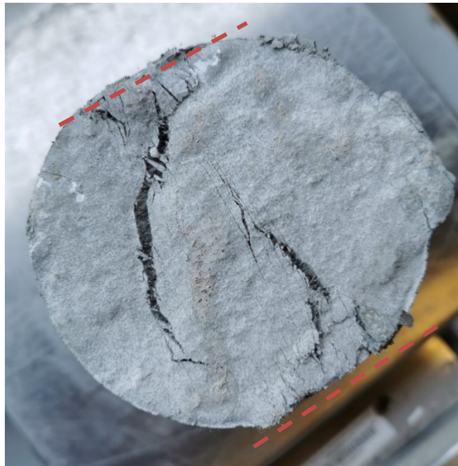
Εικόνα 4.33: Φαινόμενο διαπλάτωσης δοκιμίου
