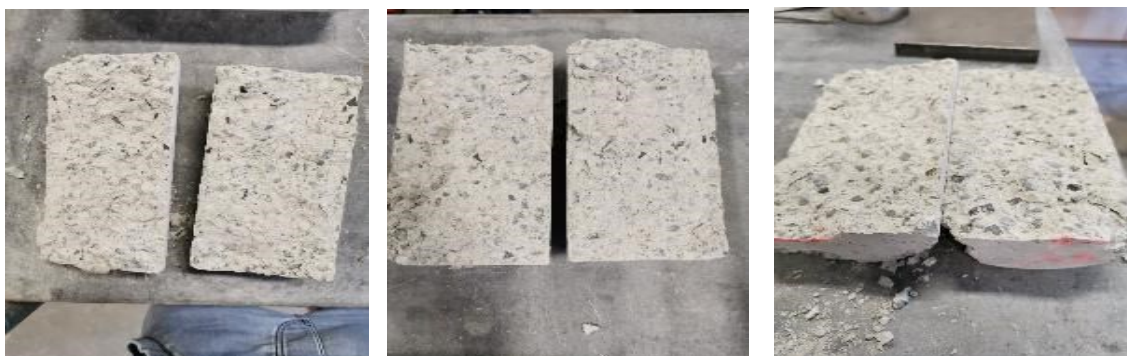
Εικόνα 4.27: Φωτογραφική απεικόνιση δοκιμίων μετά τα πειράματα έμμεσου εφελκυσμού
