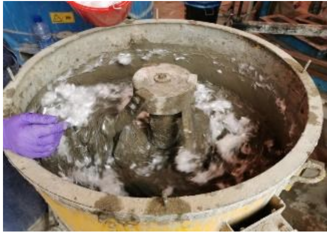
Εικόνα 4.19: Παραγωγή του μίγματος E3 στη μηχανή ανάμιξης
