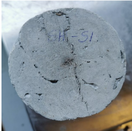
Εικόνα 4.32: Δοκίμιο μετά από πείραμα έμμεσου εφελκυσμού (πολλαπλές ρηγματώσεις)
