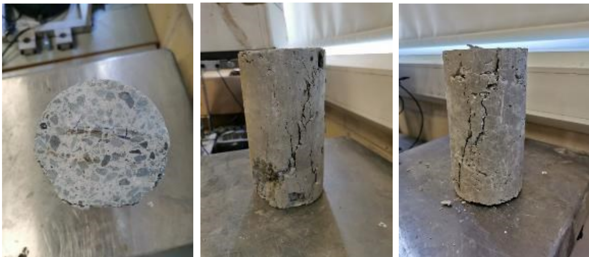
Εικόνα 4.26: Φωτογραφική απεικόνιση δοκιμίων μετά την αστοχία
