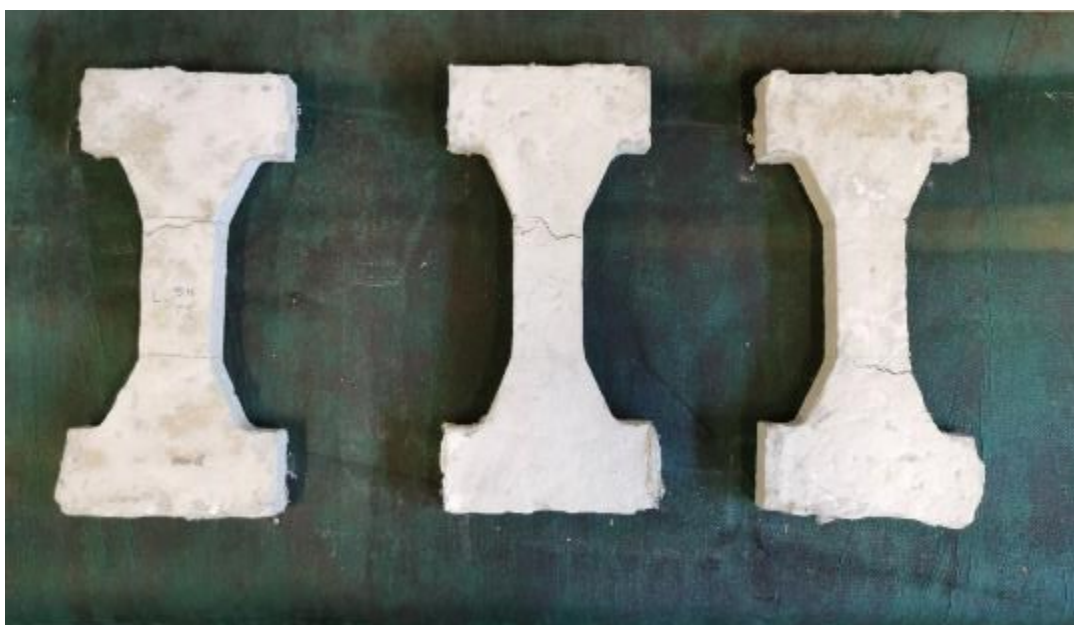
Εικόνα 4.31: Οι ρηγματώσεις στα δοκίμια dogbone μετά την ολοκλήρωση των πειραμάτων
