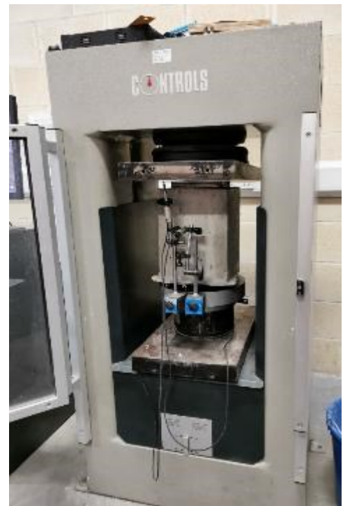
Εικόνα 4.42: Τετραγωνικά δοκίμια σε θλίψη του εσωτερικού πυρήνα
