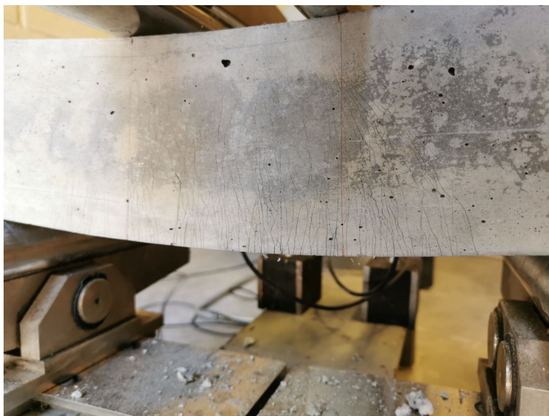
Εικόνα 4.35: Ανάπτυξη πολλαπλών ρηγματώσεων από την ακραία εφελκόμενη ίνα (Πείραμα κάμψης 4 ων σημείων)
