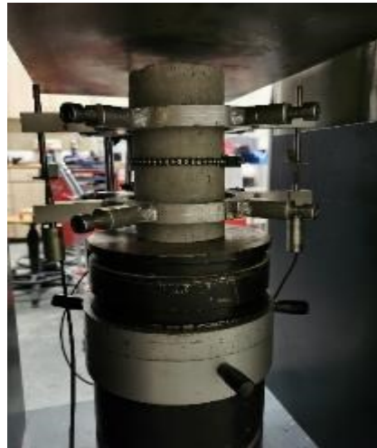
Εικόνα 4.24: Μεταλλικά στηρίγματα για τοποθέτηση κατακόρυφων LVDTs
