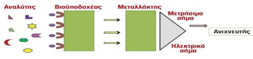
Σχήμα 6.1: Σχηματική απεικόνιση λειτουργίας ενός βιοαισθητήρα {97} .
